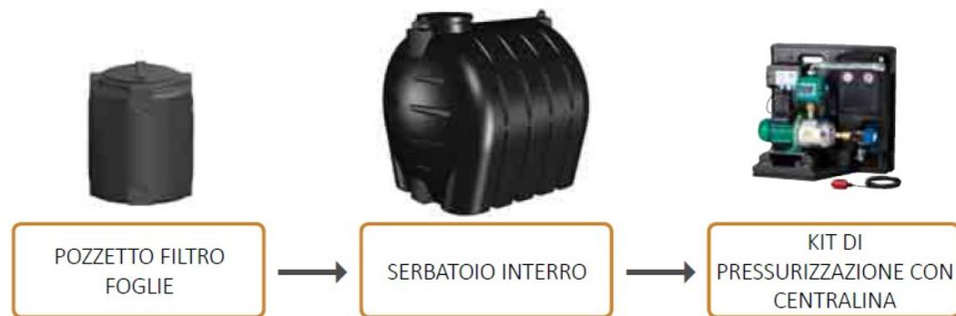
Il reintegro di acqua nel serbatoio dalla rete acquedottistica deve essere gestito con sistemi dotati di dispositivi rompi vuoto in conformità alla norma UNI 1717:2002 per evitare la contaminazione della rete acquedottistica, oltre che a mantenere le 2 condutture distinte e separate. L'acqua di rete (potabile) e l'acqua piovana (non potabile) come prescritto nel testo unico per l'ambiente D.lgs 152/2006 devono avere delle condutture separate.
