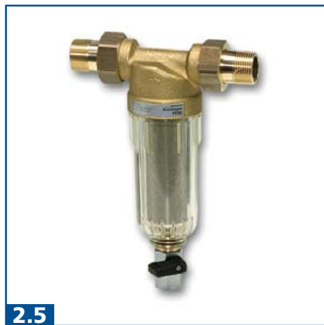
FIG. 2.5. FILTRO CON LAVAGGIO SEMPLICE MANUALE. I SEDIMENTI, TRATTENUTI NELLA PARTE INFERIORE DEL FILTRO, VENGONO ELIMINATI ATTRAVERSO LO SCARICO DURANTE IL LAVAGGIO, OTTENUTO MANUALMENTE MEDIANTE L'APERTURA DELLA VALVOLA SULLO SCARICO (HONEYWELL).
